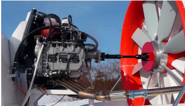
Силовая установка СВП "СЛАВИР"
